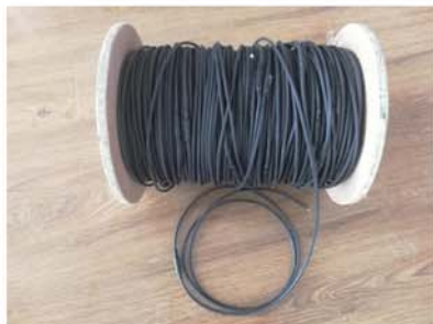
图2-4定点式弱光栅应变传感光缆
